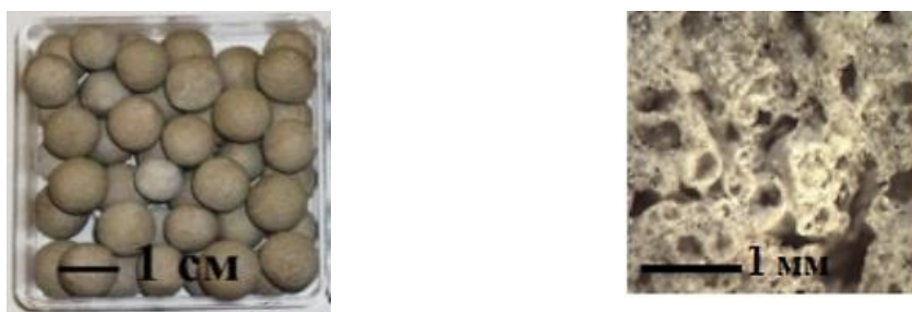
Рис. 2. Гранулированный пеносиликат и его структура Fig. 2. Granular foam silicate and its structure
