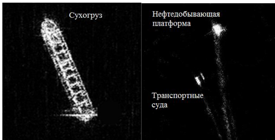
Рис. 1. Транспортные суда и нефтедобывающая платформа на РЛИ в режимах ДПР и ОР с КА «Кондор-Э»
